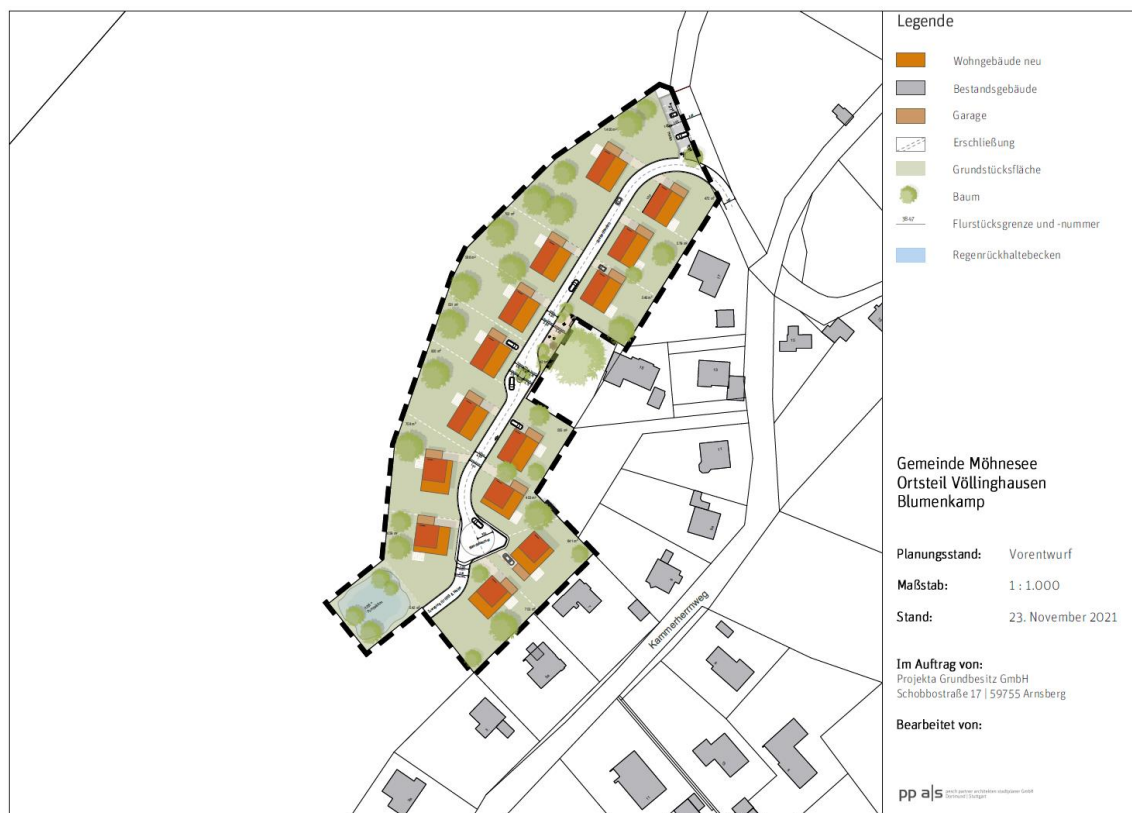
Abb. 8: Darstellung der geplanten Bebauung mit Regenrückhaltebecken.
